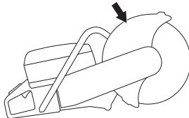
Проверка состояния режущего диска и его щитка.
